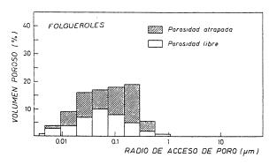
Fig. 12.—Distribución de tamaños de poro, obtenida mediante porosimetría por inyección de mercurio.
