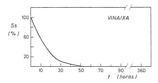
Fig. 23.—Desorción de agua: Grado de saturación (Ss) en función del tiempo (t).
