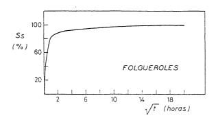
Fig. 13.—Absorción libre de agua: Grado de saturación (Ss) en función del tiempo  $(\sqrt{1})$ .
