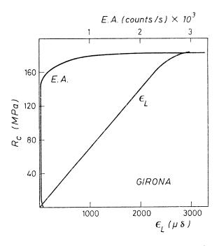
Fig. 8.—Curva esfuerzo-deformación con emisión acústica.
