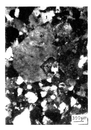
Fig. 10.—Textura de la arenisca de Folgueroles. Se aprecian granos de cuarzo (1), feldespatos (2) y calcita (3), así como fragmentos líticos (4). (M.O.P., N.C.).
