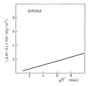
Fig. 7.—Absorción capilar: Incremento de peso por unidad de superficie ( $\triangle$  M/S) en función del tiempo ( $\sqrt{t}$ ).
