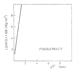
Fig. 15.—Absorción capilar: Incremento de peso por unidad de superficie ( $\triangle$ M/S) en función del tiempo ( $\sqrt{t}$ ).
