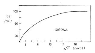
Fig. 5.—Absorción libre de agua: Grado de saturación (Ss) en función del tiempo  $(\sqrt{t})$ .
