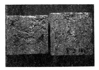
Fig. 17.—Aspecto de dos probetas de la piedra de Folgueroles transcurridos los diez ciclos de cristalización de sales, después de lavadas.
