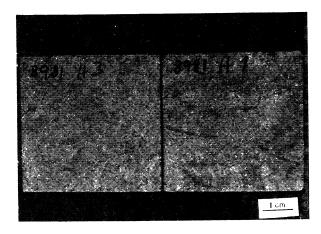
Fig. 9.—Aspecto macroscópico de la arenisca de Folgueoles. Puede observarse cierta heterometría en el tamaño de grano así como la presencia de poros.
