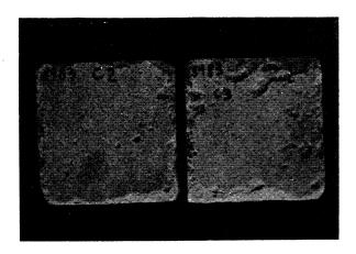
Fig. 26.—Probetas de piedra de Vinaixa después de los ciclos de cristalización de sales, tras ser lavadas.
