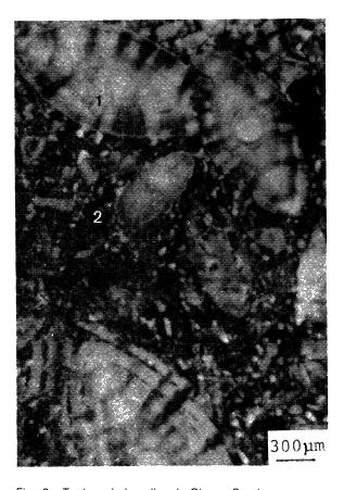
Fig. 2.—Textura de la caliza de Girona. Se observan nummulites interpenetrados (1) envueltos en una matriz arenosa (2). Microscopía óptica de polarización (M.O.P.), nicoles paralelos (N.P.).
