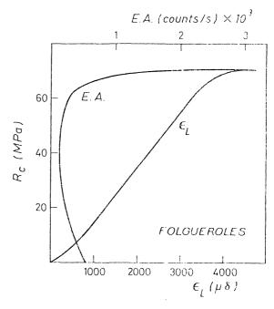
Fig. 16.—Curva esfuerzo-deformación con emisión acústica.
