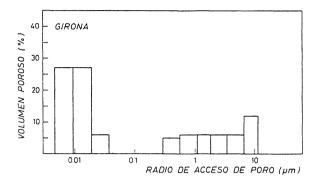
Fig. 4.—Distribución de tamaños de poro, obtenida mediante porosimetría por inyección de mercurio.
