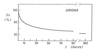
Fig. 6.—Desorción de agua: Grado de saturación (Ss) en función del tiempo (t).
