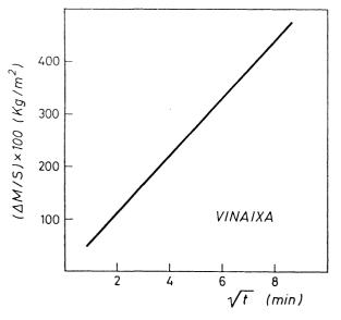
Fig. 24.—Absorción capilar: Incremento de peso por unidad de superficie ( $\triangle$ M/S) en función del tiempo ( $\sqrt{t}$ ).
