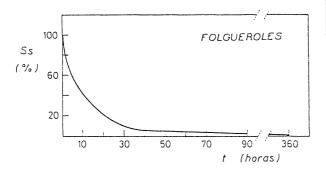
Fig. 14.—Desorción de agua: Grado de saturación (Ss) en función del tiempo (t).
