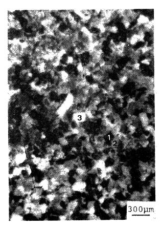
Fig. 19.—Textura de la caliza de Vinaixa. Destaca la presencia de granos micríticos (1) —oscuros—, espáticos (2) —más claros— y de cuarzo (3) —blancos—. (M.O.P., N.P.).
