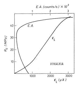
Fig. 25.—Curva esfuerzo-deformación con emisión acústica.
