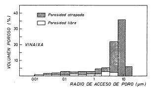
Fig. 21.—Distribución de tamaños de poro, obtenida mediante porosimetría por inyección de mercurio.
