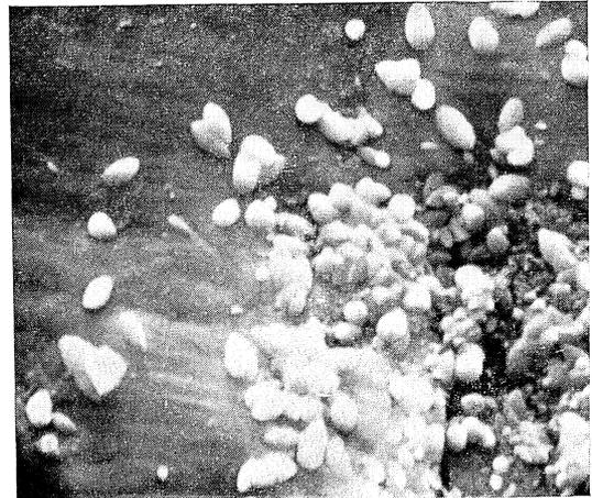
Fig. 4.—Muestra 1: Con  $C_2S$ , hidratada con agua quieta durante 6 minutos. Cristales mal formados de CH sobre una capa de SCH. 5.400  $\times$ .
