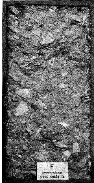
Hormigón mantenido en inmersión hasta alcanzar constancia de peso.
