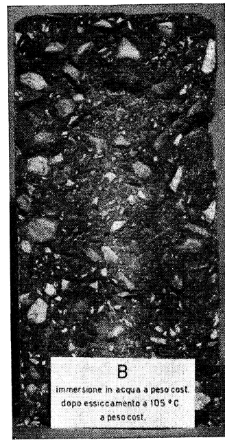
Hormigón mantenido bajo agua hasta constancia de peso y, después, desecado a 105°C hasta peso constante.
