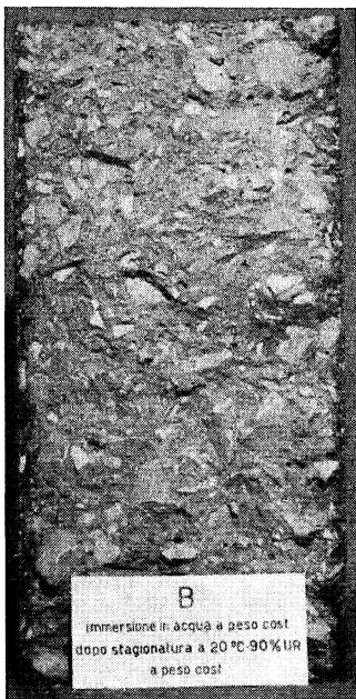
Hormigón mantenido bajo agua hasta alcanzar constancia de peso; después conservado a 20°C y 90 % H.R. hasta alcanzar constancia de peso.
