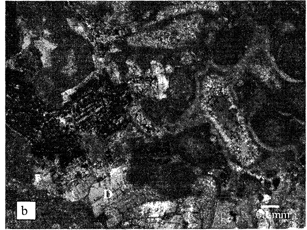
Figura 8.- «Borriol Roja». Microfotografía de dolomita tipo «saddle» del cemento interparticular. a) luz transmitida. b) luz polarizada. Figure 8.- «Red Borriol». Microphotograph of «saddle» dolomite of the interparticle cement. a) transmitted light. b) polarized light.
