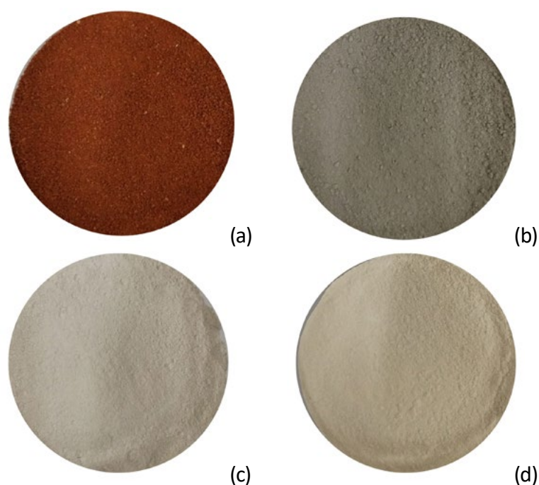
Figure 1. (a) Soil, (b) Portland Cement CP-V, (c) Metakaolin, and (d) Limestone filler.
