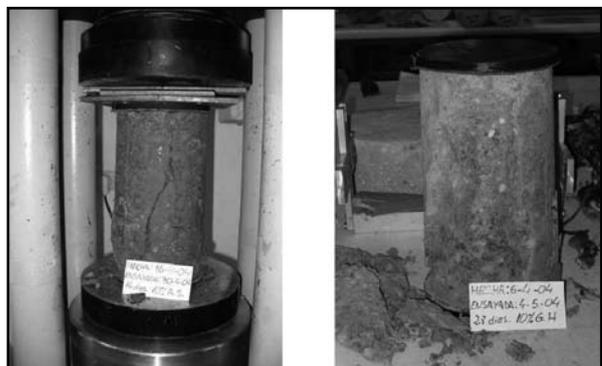
Figura 4. Prensa de ensayo a compresión y probetas ensayadas.
